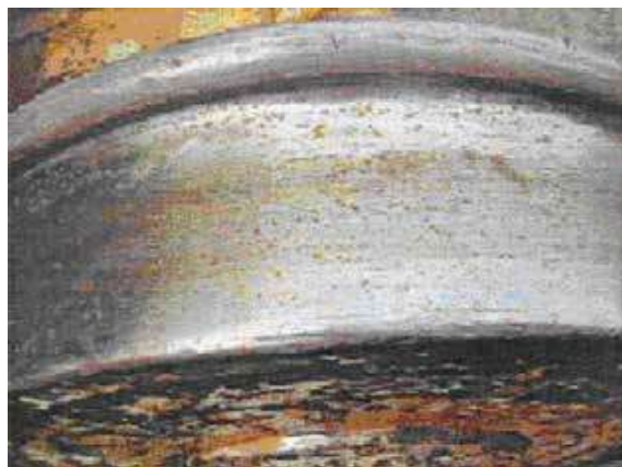
Fig 125. Limite de fissuration circonférentielle associée au retournement
