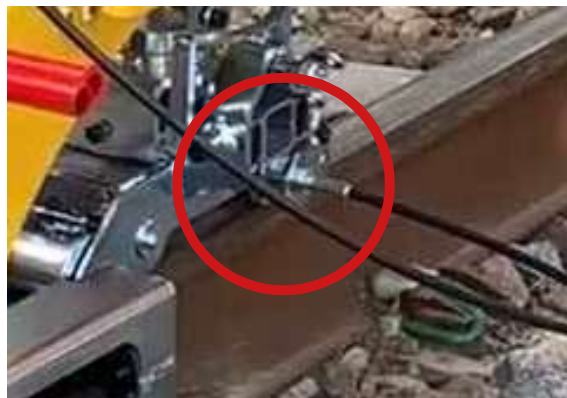
Fig 43. Débrancher le câble du frein
